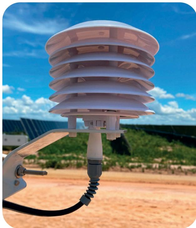
Abrigo Meteorológico RHRS instalado com um Sensor Termo-Hidrômetro SS-TRH-RS485 em uma UFV.
